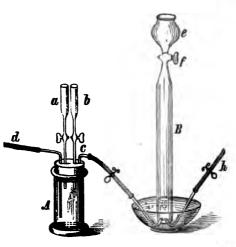
Reaction; die dabei entwickelten Gase (N, NO und  $CO^2$ ) sammelt man in B auf. Ist die Zersetzung (welche man durch Umschütteln von A befördert) vollendet, so führt man das in A noch befindliche Gasgemenge nach B über, indem man durch das Trichterrohr b ausgekochtes Wasser einfliessen lässt (oder indem man noch einmal  $CO^2$  einleitet).
